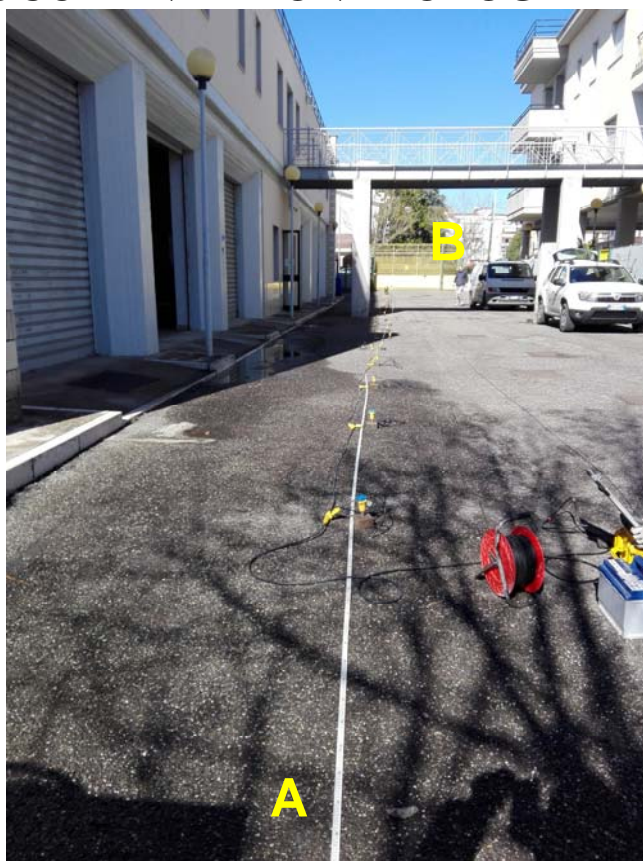
Foto 1. Prospezione sismica a rifrazione SIS 1 – MASW 1
